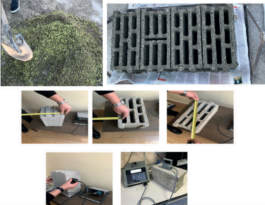
Şekil 2. Briket üretimi, boyut konfigürasyon ve deneysel şema
