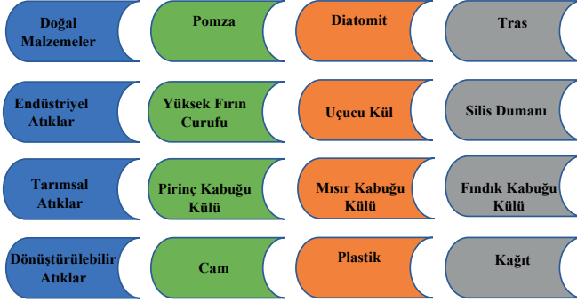
Şekil 2.1. Yaygın kullanılan yeşil beton malzemeleri [2]
