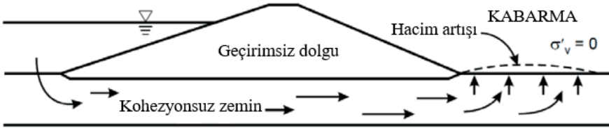
Şekil 10. Dolgunun mansap topuğunda borulanma sonucu meydana gelen kabarma (Pabst vd.'den, 2012).
