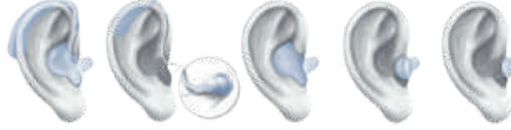
Şekil 4. İşitme Cihazı Tipleri (Sırasıyla kulak arkası, kulak arkası hoparlör kanal içi, kulak içi, kanal içi, tamamen kanal içi) (3)
