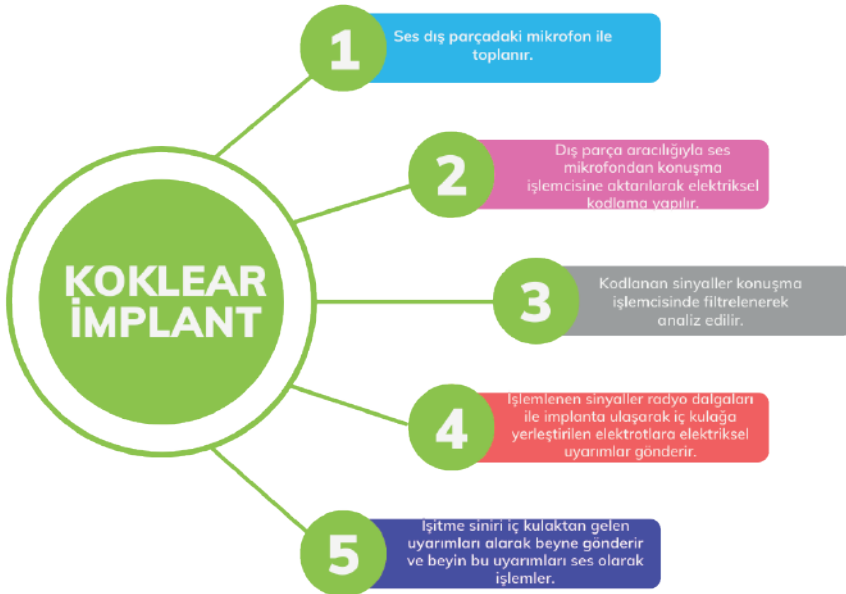
Şekil 5. Koklear implantın çalışma mekanizması (11).
