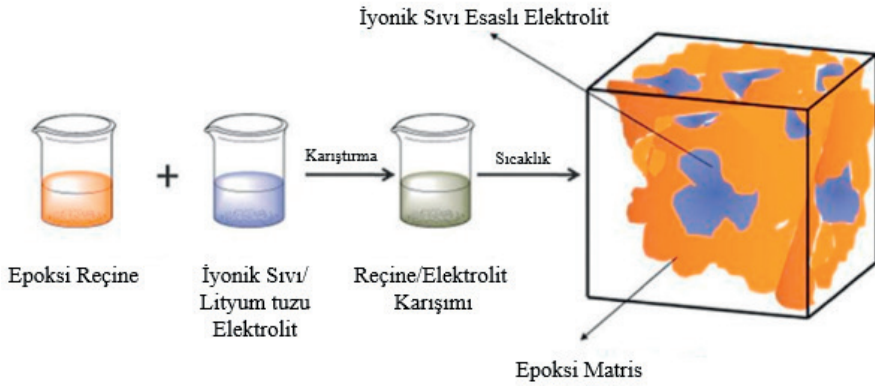
Şekil 6: Epoksi reçine/iyonik sıvı esaslı katı polimer elektrolitlerin üretim prosedürü şematik gösterimi [37].
