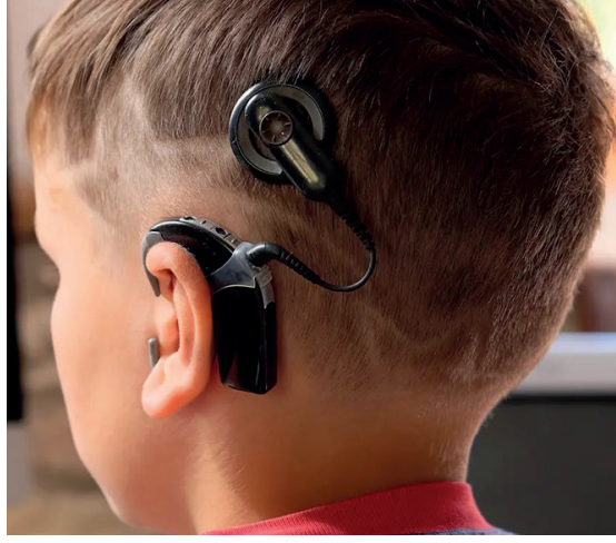
Şekil 8: Koklear implantın dış parçası.
