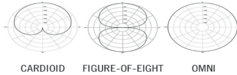
Şekil 4. Her Yön veya yönsüz (Omnidirectional), Çift Yön (Bidirectional), Tek yönlü (Unidirectional/Cardioid).
