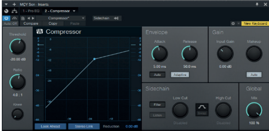
Şekil 24. Diyalog için kompresör uygulaması.
