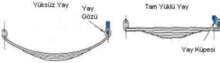
Şekil 2 – Yaprak yayın yüksüz ve ve tam yüklü halleri gösterilmiştir.
