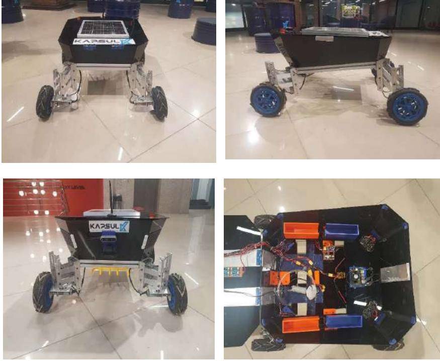
Şekil 6. Geliştirilen tarımsal insansız kara aracının farklı açılardan görünümü
